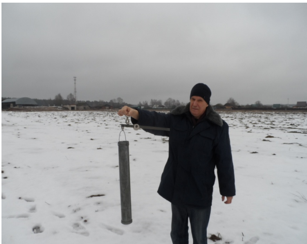
Рисунок 1 - Определение высоты и плотности снежного покрова при помощи переносной снегомерной рейки и весового снегомера (мелиоративный объект «Тинки-2», Рязанская область, 2020 г.)
