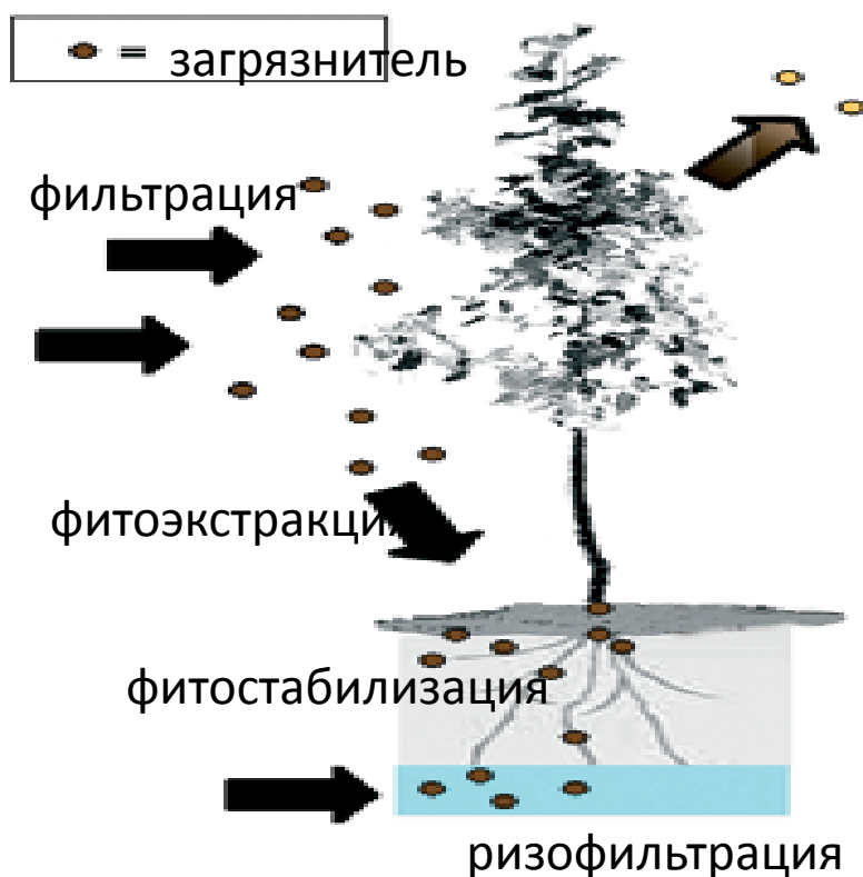
Рисунок 2 – Принципиальная схема фиторемедиации
