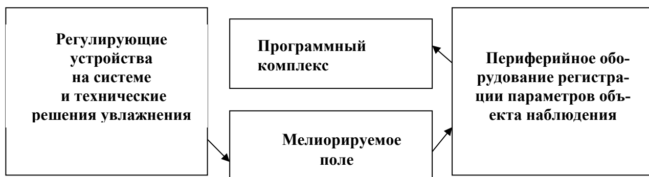
Рисунок 3 - Принципиальная схема оперативного мониторинга на мелиорируемом поле
