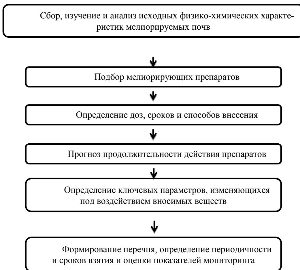
Рисунок 1 - Схема последовательности действий по определению показателей мониторинга почв при их мелиорации с применением искусственных субстратов
