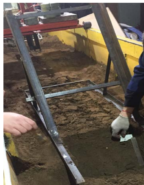
Рисунок 1 - Экспериментальный грунтовый лоток с установленным рабочим органом рыхлителя
