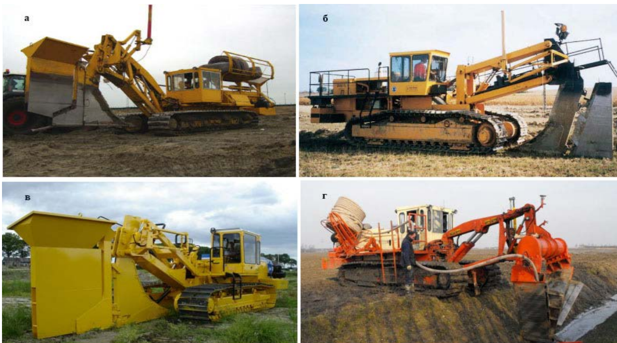
Рисунок 7 - Самоходные бестраншейные дренажные машины на специальных гусеничных шасси с вертикальными рабочими органами фирм Mastenbroek (а), Hollandrain (б), Inter Drain (в) и с рабочими органами V-образной формы фирмы Mastenbroek (г)
