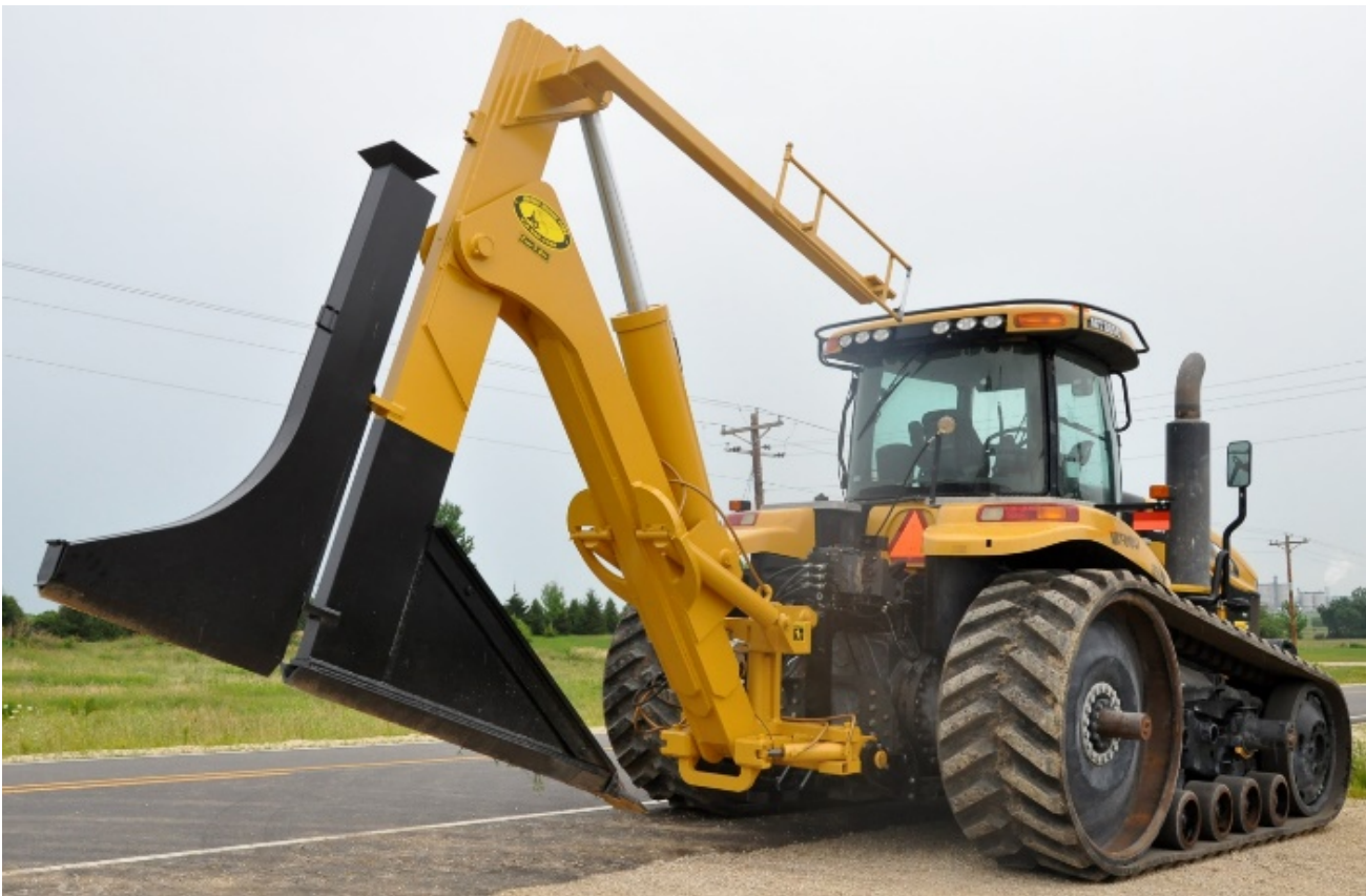
Рисунок 9 – Прицепной (а) и навесные (б) дренажеры фирм O'Connell Farm Drainage Plows, Johnson Drainage Plows
