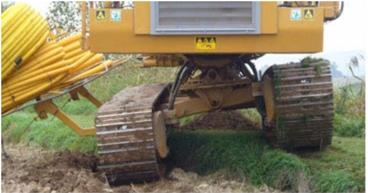
Рисунок 8 – Подвеска гусениц к базовой раме
