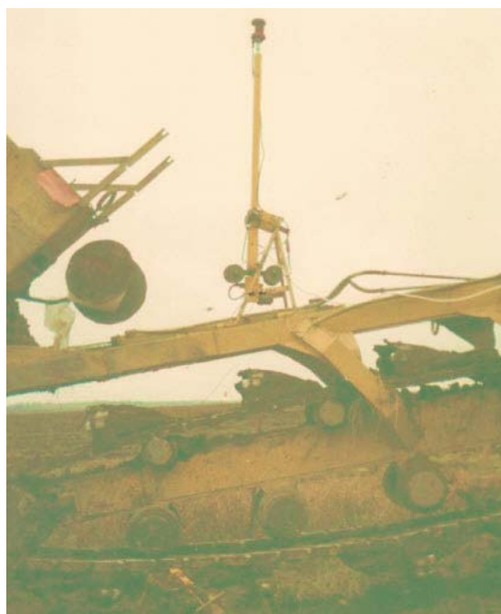
Рисунок 3 – Установка актуатора на раме дреноукладчика ЭТЦ-202Б
