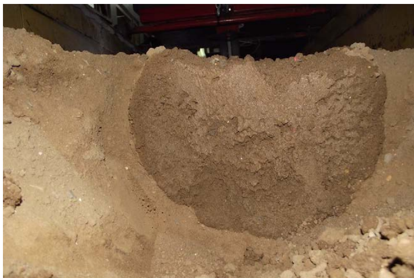
Рисунок 2 - Контур увлажнения капельницы с расходом 2л/ч
